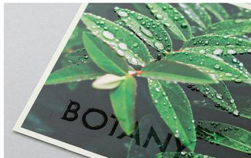
葉っぱの水滴上に特厚のニス (100 $\mu$ ) を乗せることで、実際に水滴が乗っているように見せています。左下のロゴはあえて印刷しないで同じニスをのせて表現しています。
