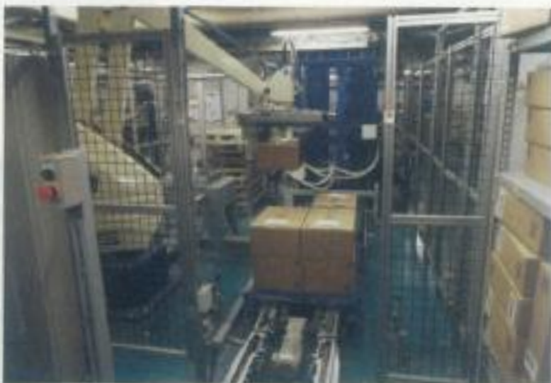
写真8 パレタイジングロボットが段ボールをパレットに積んで出荷。高さが異なるものが流れてきても平らな面になっていくように自動で積んでいく
