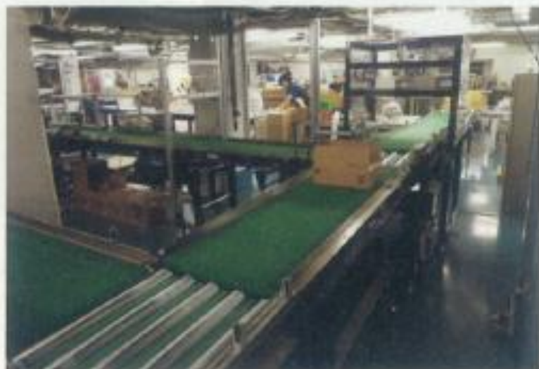
写真4 梱包された印刷物は封が開いた状態で（左下から右上へ）流れるが、途中、B判系列の手で梱包した段ボールも合流してくる
