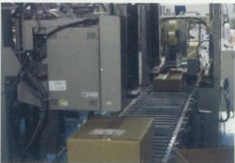
写真6 段ボール（右上から左下へ）の上から封緘のテープを貼り、その次の宅配便の配送ラベルを貼る
