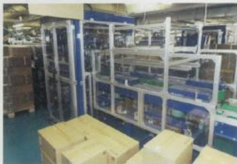
写真2 シュリンクされた印刷物を段ボールに梱包するユニット（印刷物は左奥から右手前へ）
